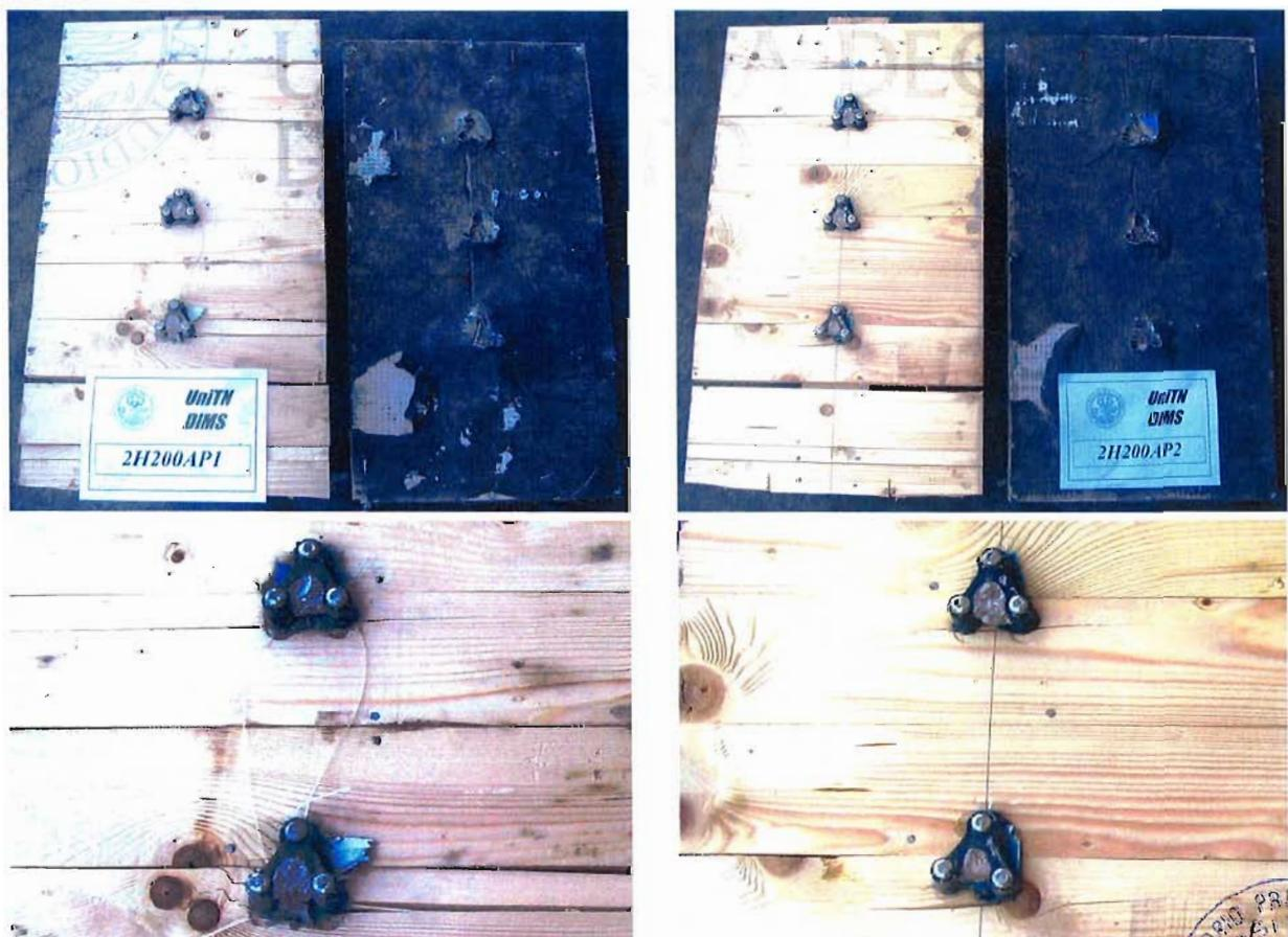
Figura 12 - Modalità di rottura di provini tipo 2H 200AP.
