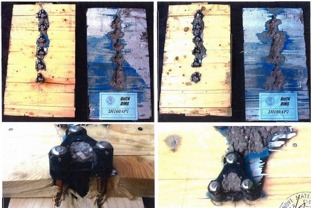
Figura 8 - Modalità di rottura di provini tipo 2H 100AP.
