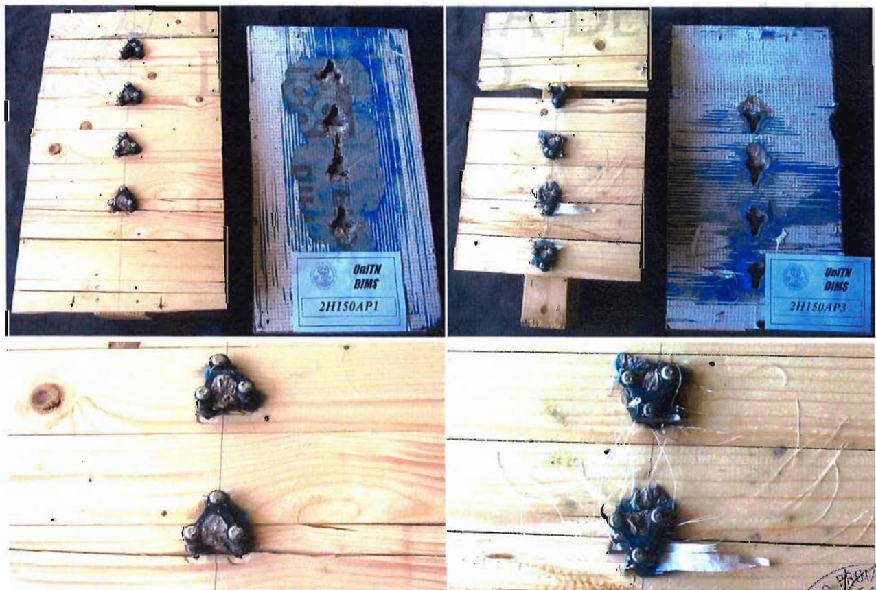
Figura 10 - Modalità di rottura di provini tipo 2H 150AP.
